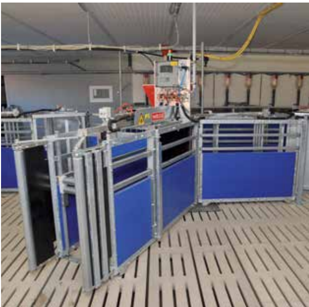
Estación electrónica de alimentación SowComp
