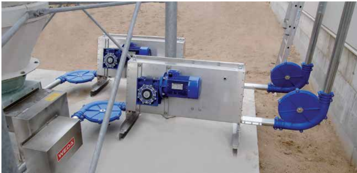
Приводная станция K1
