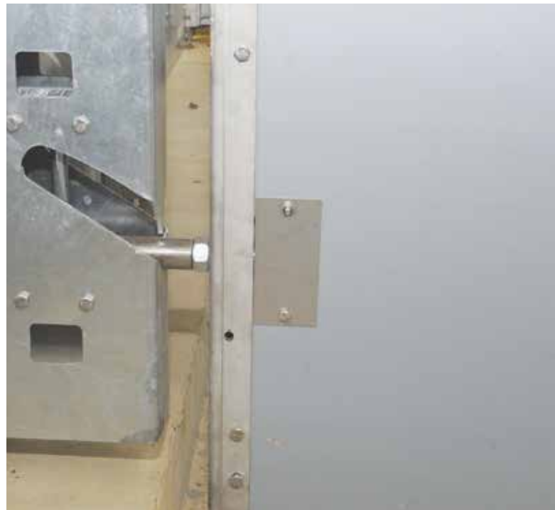
Quick.Gate – Le mécanisme intégré soulève la porte au-dessus de la paille.
