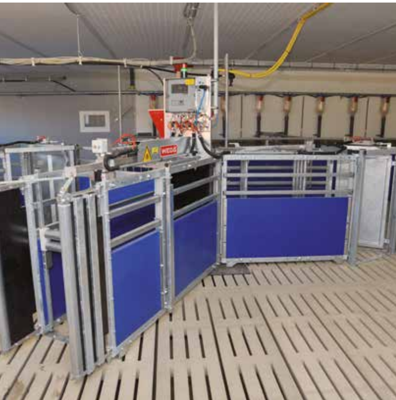
Station d'alimentation Sow.Comp
