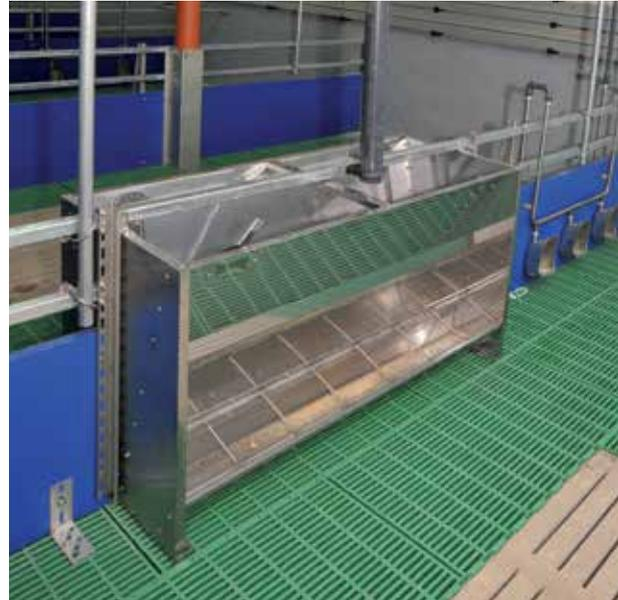
Alimentador doble automático de alimento seco de acero inoxidable con 2x7 alimentadores
