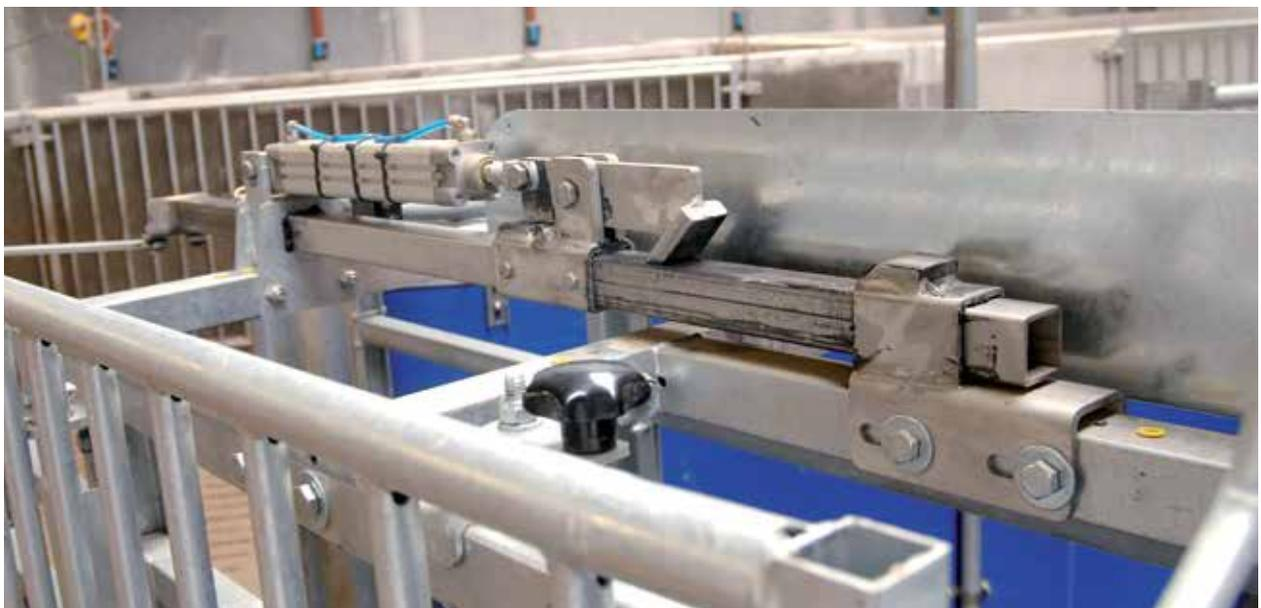
Las puertas de la estación electrónica de alimentación por autoabastecimiento de cerdas se cierran por medio de un mecanismo neumático a baja presión, el cual está asegurado mediante un bloqueo mecánico. (Nota: Se ha quitado la carcasa de protección para una mejor visualización).
