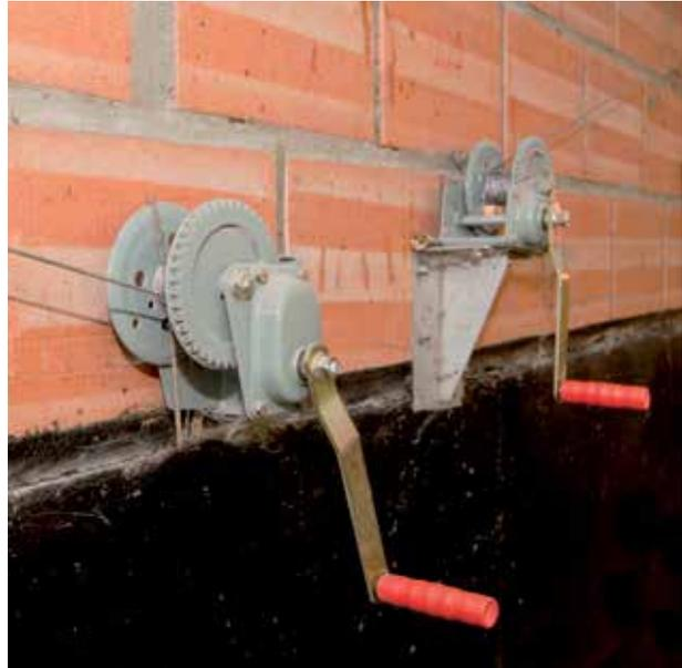
Mecanismo de manivela para dosificador volumétrico
