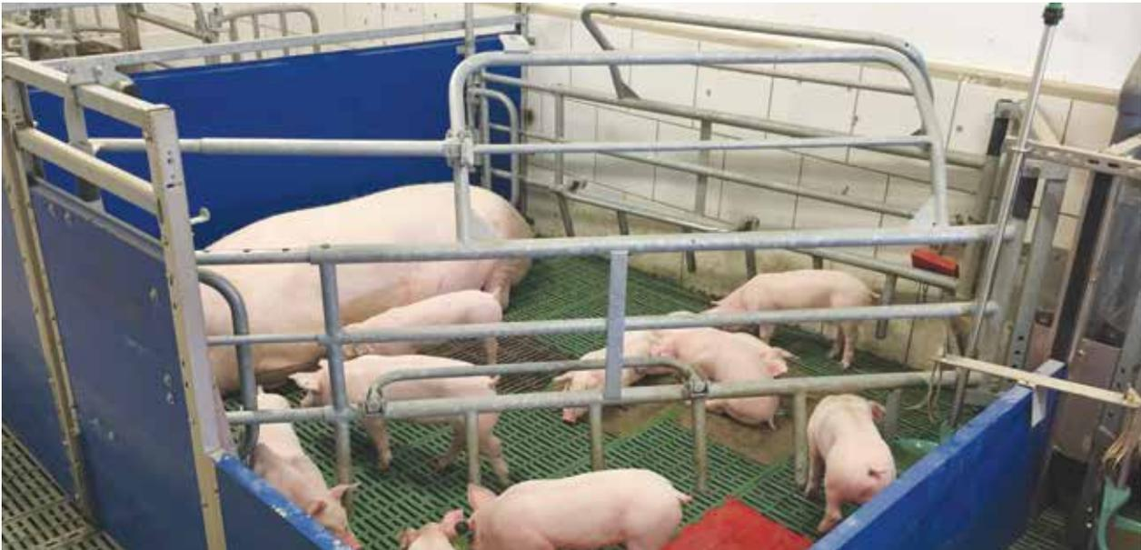
Con un lateral pivotable se crea un enorme espacio abierto de 6.4m<sup>2</sup> para los animales. La construcción especial del corral y un nuevo sistema de cierre crean un alto grado de seguridad en el corral.
