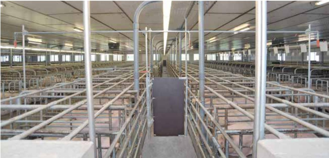
La compuerta de recela puede montarse entre la pared y el criadero o entre dos criaderos opuestas.
