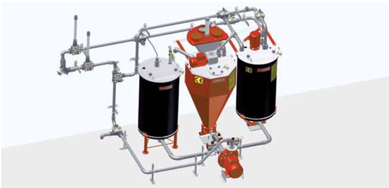
Système d'alimentation sans résidu Conticomp pour jusqu'à 1 500 porcelets
