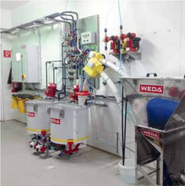
Nutrix avec deux cuves de mélange et doseur alimentaire
