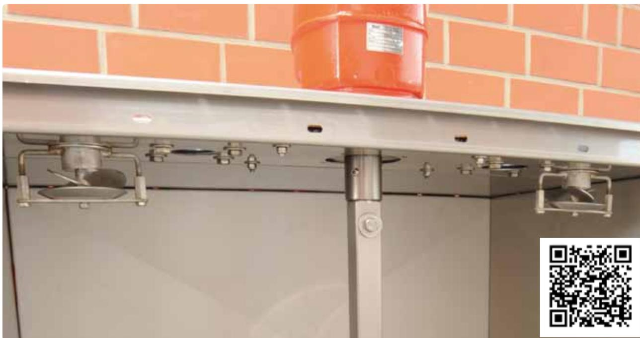
Диски внутри кормосмесительной ёмкости разбрызгивают воду, мертвые углы отсутствуют
