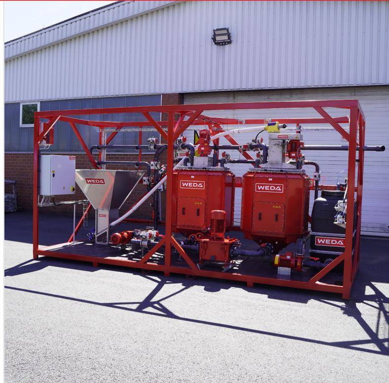
**Del plano a la ejecución:** Sistema de alimentación de insectos (construcción modular). Tamaño de la planta de hasta 10 toneladas de sustrato por día
