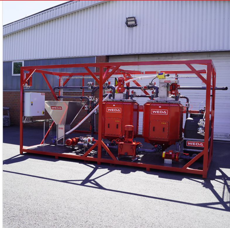
Von der Zeichnung zur Ausführung: Insektenfütterungssystem (modularer Aufbau). Anlagengröße bis zu 10 to Futtersubstrat pro Tag
