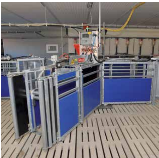
Elektroniczna stacja żywienia SowComp
