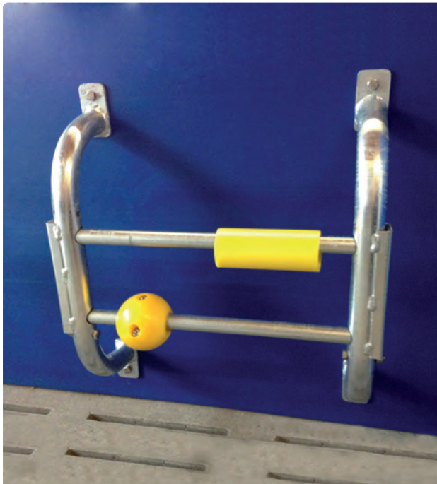
Spielzeughalter Wühlstange an der Buchtenwand montiert.
