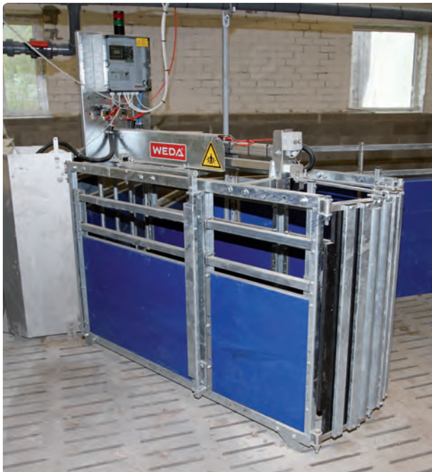
Anlernstation mit PC-Steuerung
