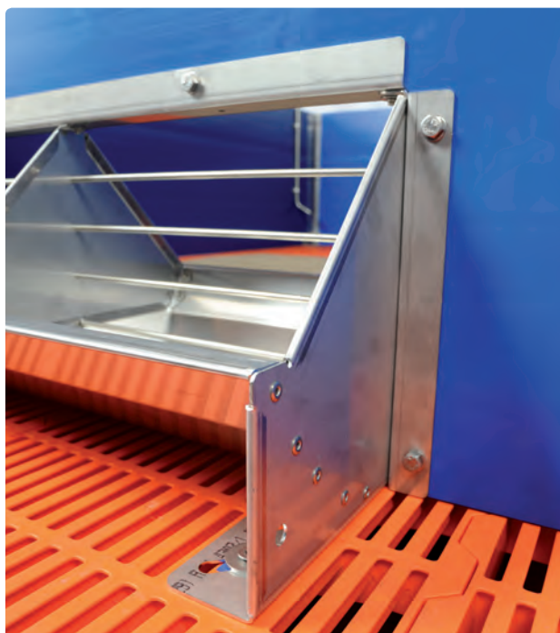
Die Verschraubung der Tröge an den Buchtenwänden und dem Spaltenboden sorgt für einen sicheren Halt.
