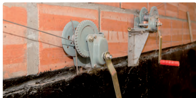
Kurbelmechanismus für Volumendosierer
