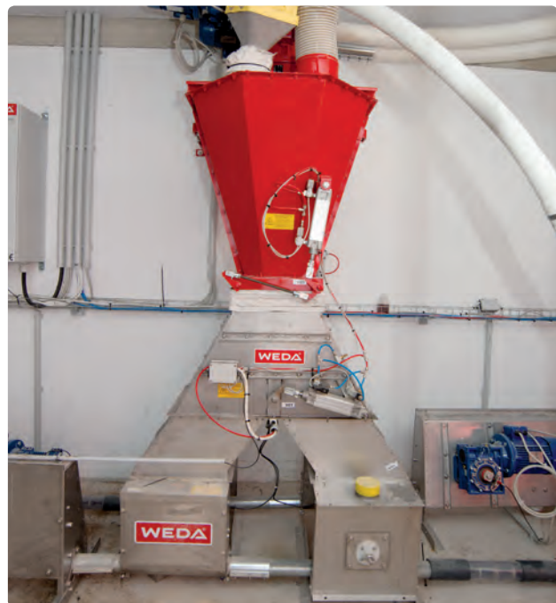
...große Produktionsbetriebe reibungslos mit Futter versorgt werden. Es können bis zu 4 Linien an einen Mischer angeschlossen werden.
