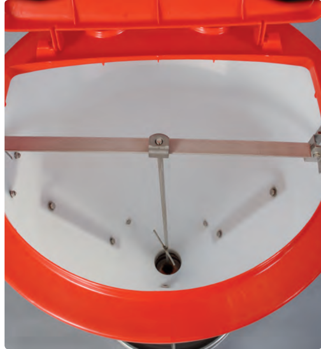
Die Innenkonstruktion verhindert eine Brückenbildung.
