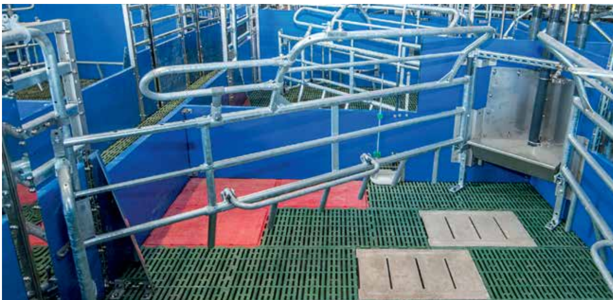
A baia de movimento em diagonal oferece muito espaço atrás da porca e possibilita um ótimo auxílio para o parto.
