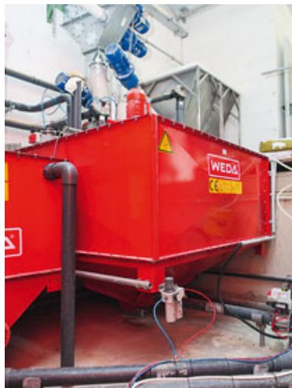
*Im 2400 l großen Anmischbehälter dieser Anlage wird das fermentierte Eiweißfutter je nach Alter der Masttiere mit anderen mehligem Komponenten wie Weizen vermengt.*
