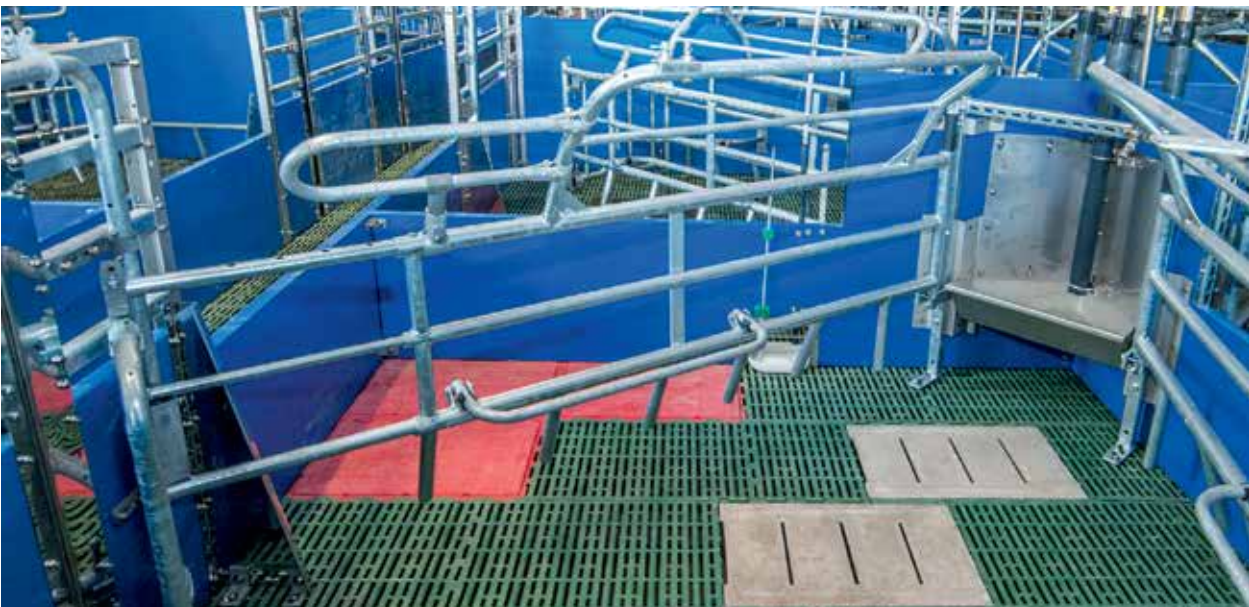
คอกที่ให้เคลื่อนที่ได้โดยอิสระแบบจัดเรียงทะแยงมุมให้มีพื้นที่กว้างด้านหลังแม่สุกร และทำให้สามารถช่วยเหลือในการทำคลอดได้ดียิ่ง
