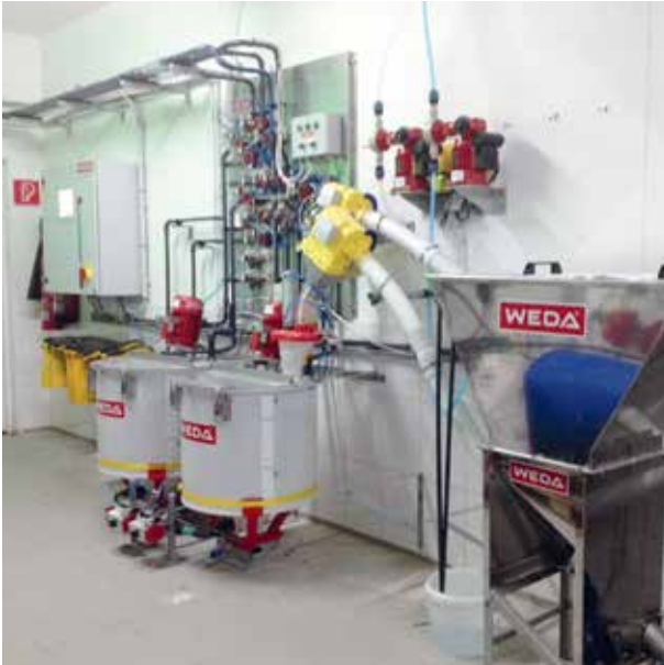
Nutrix พร้อมถังผสม 2 ถังและอุปกรณ์จัดขนาดปริมาณการป้อน FD
