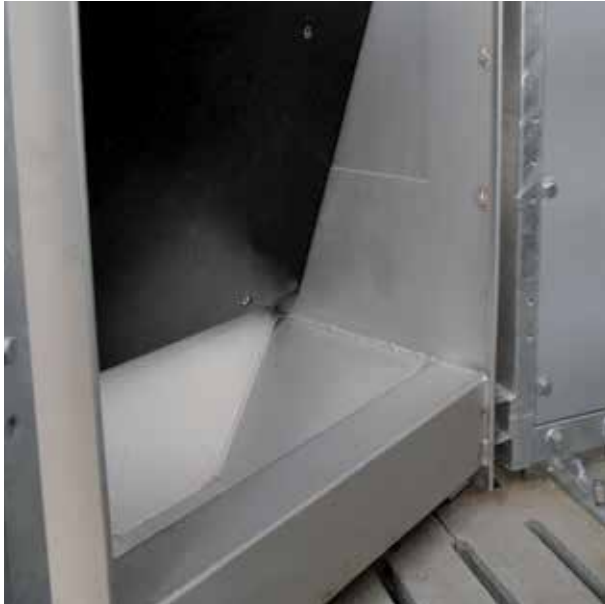
รางอาหารเหล็กแอสแตนเลสที่มีฝาปิดราง
