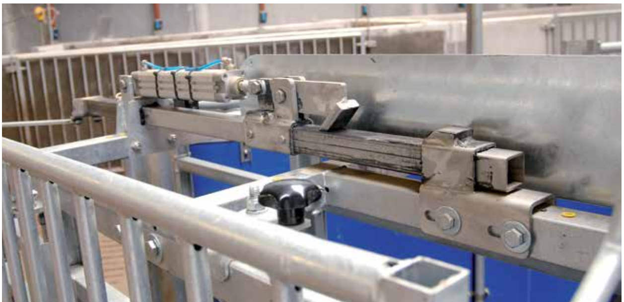
รางอาหารเหล็กแอสแตนเลสที่มีฝาปิดราง
