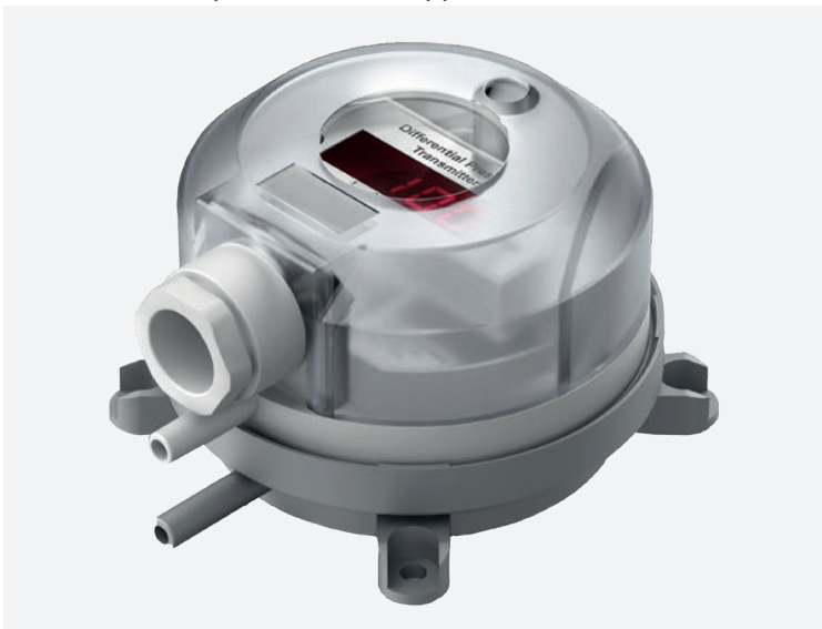
Датчик измерения разрежения, диапазон измерений: 0-100 Па, с цифровым индикатором, 0-10 В Цифровой контроль разрежения и регулирование центральной вытяжной системы
