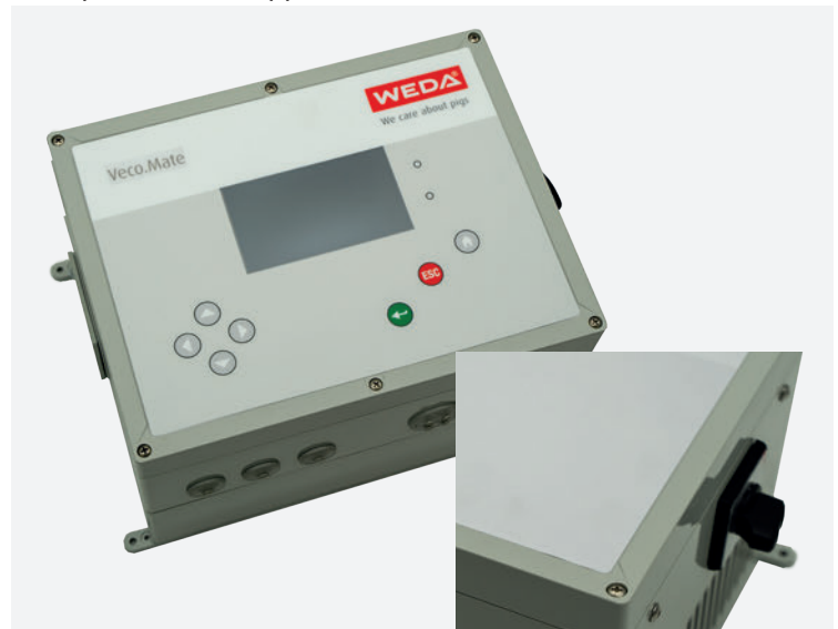
Преобразователь частоты WEDA в исполнении 6 А, 3 фазы, 400 В и 10 А, 3 фазы, 400 В Каждый имеет многополюсный синус-фильтр и байпасный переключатель
