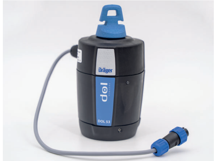
Датчик измерения концентрации аммиака, диапазон измерений: 0-300 ppm, 0-10 В, 24 В постоянного тока
