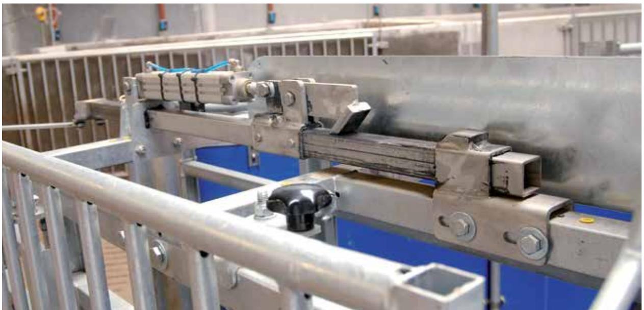
电子饲喂站的门通过低气压的气动机构关闭(机械互锁)。(注意:外罩被移除,以获得更好的展示效果)。
